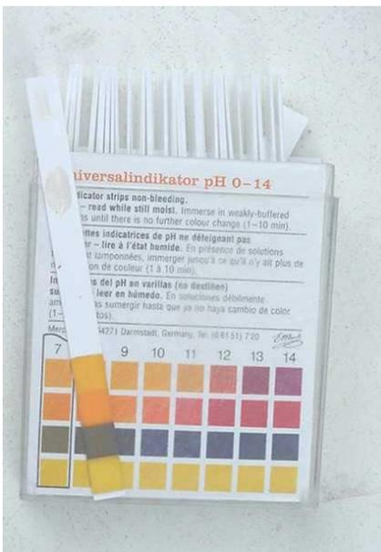
Feststellung durch den 4-Farbvergleich des pH-Wertes
