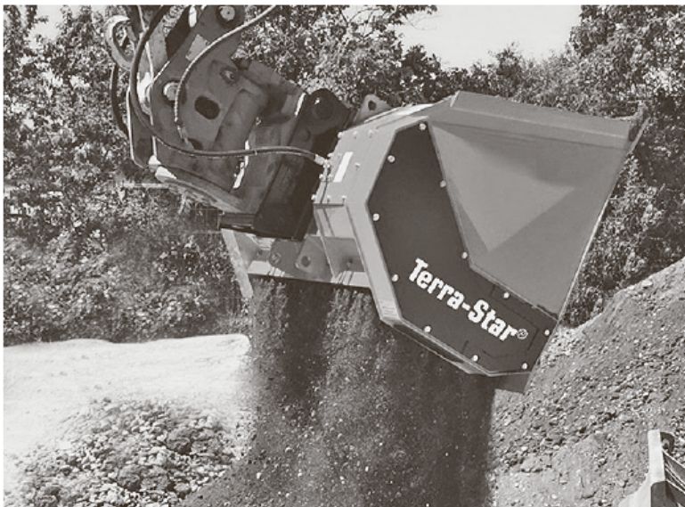
Der Terra-Star kann sowohl am Bagger ab 4 t als auch am Radlader ab 3 t angebaut werden. FOTO: KRONENBERGER
