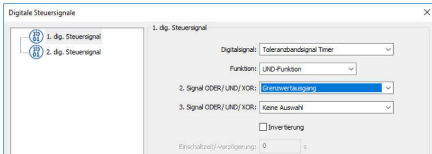
Das 1. digitale Steuersignal soll auf dem PhotoMOS®-Relais ausgegeben werden und eine Warnhupe ansteuern, sobald beide Bedingungen erfüllt sind (Toleranzband Timer überschritten UND Istwert über 100 °C).
