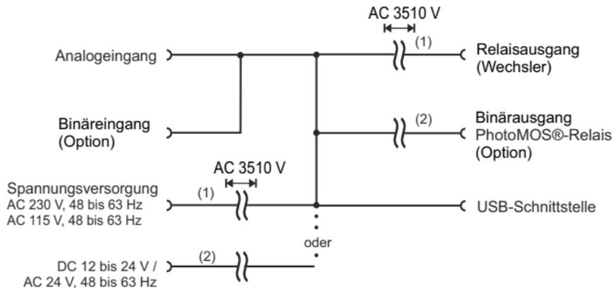
(1) Die Spannungsangaben entsprechen den Prüfwechselfspannungen (Effektivwerte) gemäß DIN EN 61010-1:2011-07 für die Typprüfung.
