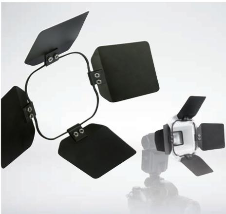
Die Abschirmklappe erzeugt ein sehr hartes Licht mit hoher Brillanz und gestattet die bessere Begrenzung des Lichtstromes durch freie Drehbarkeit der 4 Klappen. Einsatzbereiche: Sachaufnahmen und alle Motive, bei denen eine klare Abgrenzung des Lichtstroms notwendig ist.
