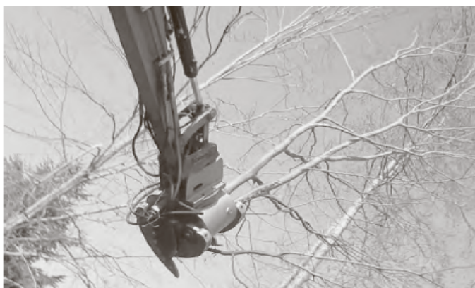
Mit der ebenfalls angebotenen Baumschere lassen sich Baumstämme problemlos abscheren und gleichzeitig greifen.
