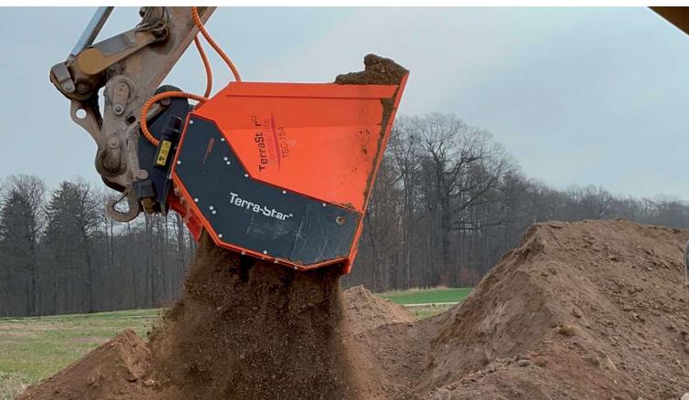
Der Terra-Star kann dank wechselbarer Wellen nicht nur sieben, sondern auch feinsieben, zerkleinern und Kalk untermischen. Quelle: Kronenberger Oecotec
