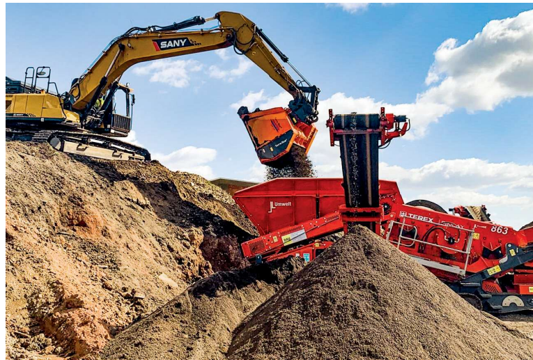
Erdrollen aufbrechen und wertvolles Material gewinnen. Wird der Terra-Star zur Aufgabe des Siebmaterials in den Trichter der Siebanlage eingesetzt, so erhöht sich dadurch der Anteil des wiederverwendbaren Bodens evident.
