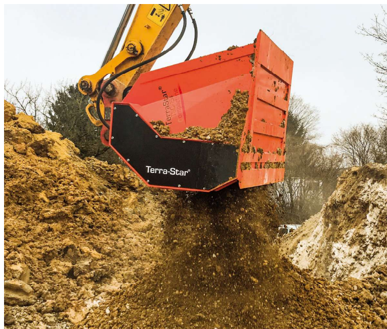
Der Terra-Star lässt sich dank seiner geflanschten Wellen schnell und einfach vom Schaufelseparator zur Untermischung von Kalk in eine Siebschaufel umbauen.
