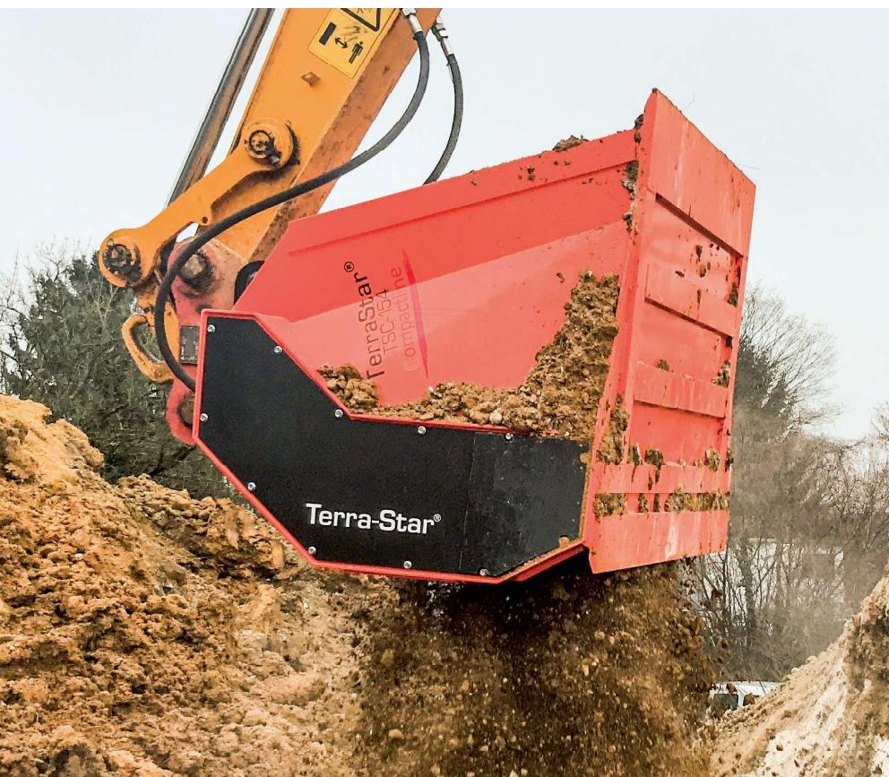
Dank geflanschter Wellen kann der Terra-Star in kürzester Zeit vom Schaufelseparator zur Untermischung von Kalk in eine Siebschaufel für verschiedene Korngrößen umgerüstet werden.
