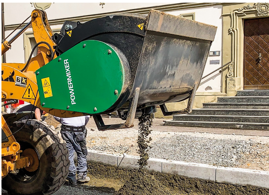
Der Powermixer ist in Größen von 100 l bis 2 m 3 Volumen erhältlich. Die Betonmischschaufel kann je nach Version sowohl an Radladern als auch an Baggern betrieben werden.
