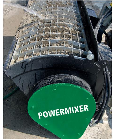
starker Beanspruchung der Schaufel verschleißt diese zusätzliche Innenschale und kann dann mit wenigen Handgriffen ausgetauscht werden. Das Schaufelgehäuse bleibt heil.
