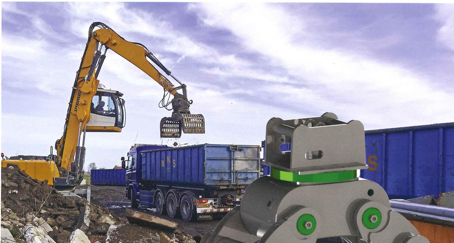
Der Modularis Sortiergreifer eignet sich vor allem für Erdaushub, Materialumschlag, zum Setzen von Steinen (empfehlen va. Bestgriff) und Felsbrocken sowie kleineren Abbrucharbeiten.
